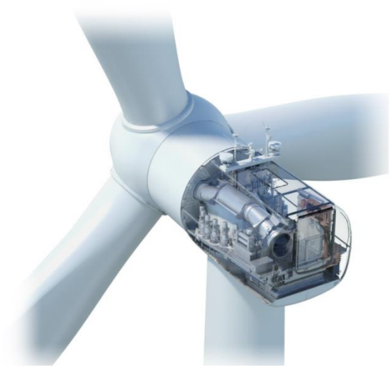
Figur 66. Exempelskiss av en nacelle samt dess innehåll.
