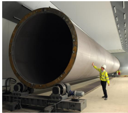
Figur 67. Fotografi på tornsegment under tillverkningsprocessen
