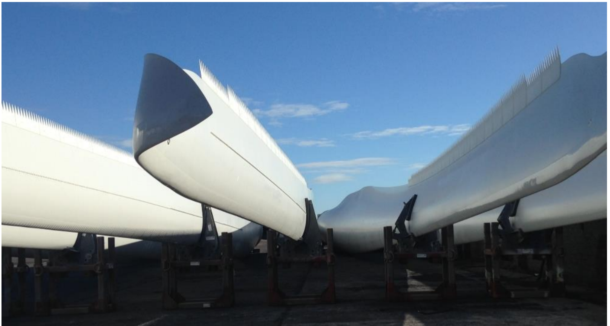
Figur 13. Serrated trailing edges på blad till vindkraftverk
