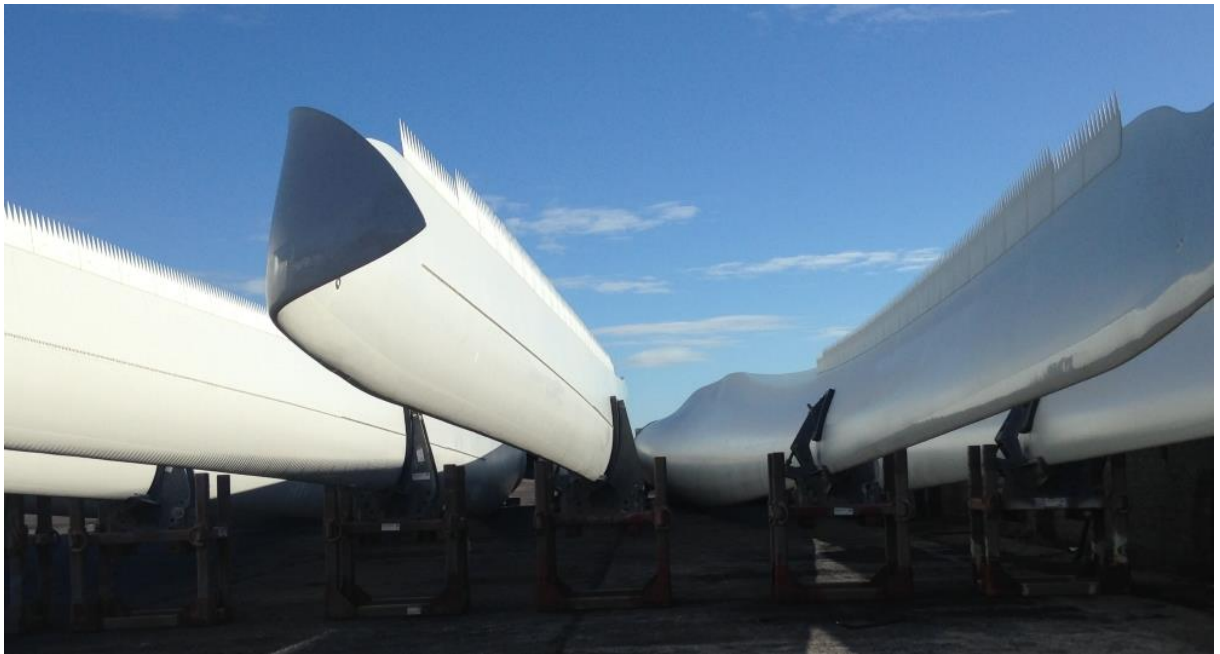
Figur 17. Serrated trailing edges på blad till vindkraftverk
