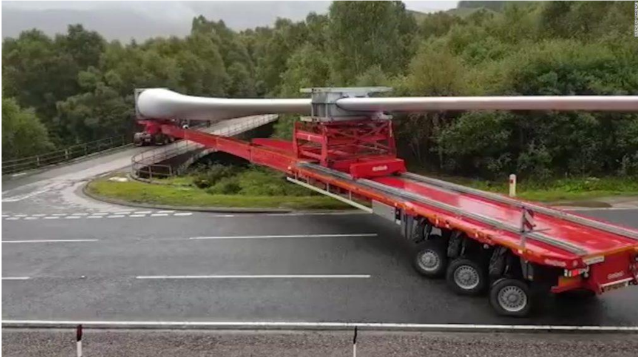
Figur 28. Transport av ett blad till ett vindkraftverk
